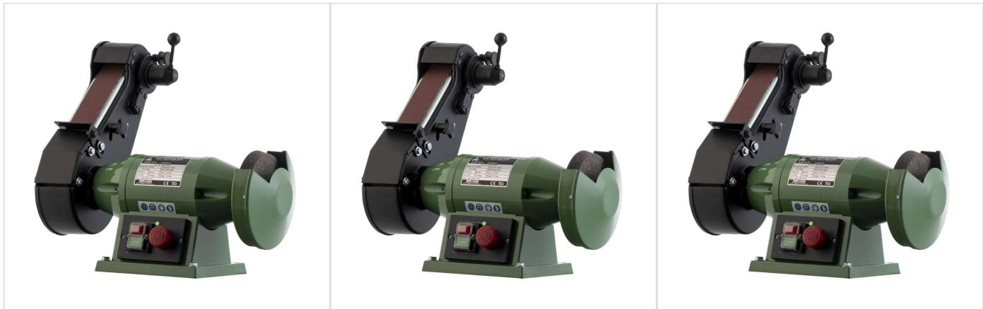
Specialschleifer zum schleifen von Messern.
