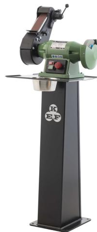
Specialschleifer zum schleifen von Messern. Ist in Zusammenarbeit mit Messerschleif-Spezialisten entwickelt.
