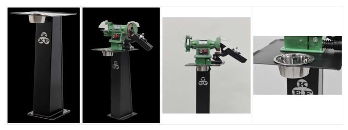
Alle Slibette Maschinen können gegen einen kleinen Mehrpreis mit Motorbrems und separatem Notstopp ausgerüstet werden. Lieferung mit Drathbürste, Band oder Poliermopp auf der linken Seite sowie auf Untergestell mit Arbeitstisch ist auch möglich. Voreingestellt zum Schleifen von Spiralbohrern - Spitzenwinkel 116-118 Grad und Freiwinkel 6-8 Grad.
