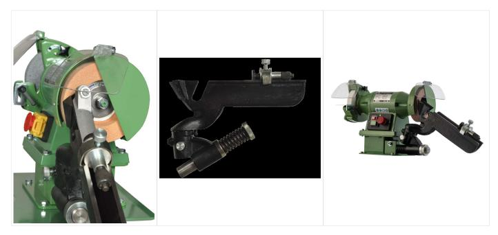
Alle Slibette Maschinen können gegen einen kleinen Mehrpreis mit Motorbrems und separatem Notstopp ausgerüstet werden. Lieferung mit Drathbürste, Band oder Poliermopp auf der linken Seite sowie auf Untergestell mit Arbeitstisch ist auch möglich. Voreingestellt zum Schleifen von Spiralbohrern - Spitzenwinkel 116-118 Grad und Freiwinkel 6-8 Grad.
