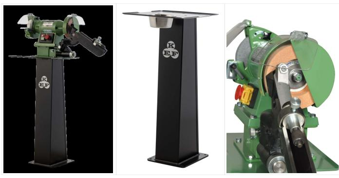
Alle Slibette Maschinen können gegen einen kleinen Mehrpreis mit Motorbrems und separatem Notstopp ausgerüstet werden. Lieferung mit Drathbürste, Band oder Poliermopp auf der linken Seite sowie auf Untergestell mit Arbeitstisch ist auch möglich. Voreingestellt zum Schleifen von Spiralbohrern - Spitzenwinkel 116-118 Grad und Freiwinkel 6-8 Grad.
