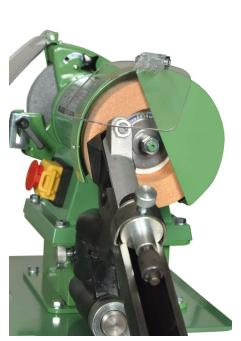
Alle Slibette-Maschinen werden gegen einen kleinen Aufpreis mit Motorbremse und separatem Notstopp angeboten.
