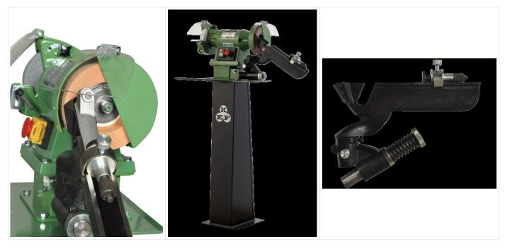
Alle Slibette Maschinen können gegen einen kleinen Mehrpreis mit Motorbrems und separatem Notstopp ausgerüstet werden. Lieferung mit Drathbürste, Band oder Poliermopp auf der linken Seite sowie auf Untergestell mit Arbeitstisch ist auch möglich. Voreingestellt zum Schleifen von Spiralbohrern - Spitzenwinkel 116-118 Grad und Freiwinkel 6-8 Grad.
