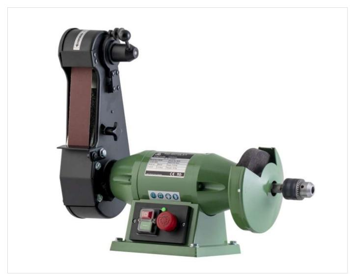
Specialschleifer zum schleifen von Schuheinlagen. Wird haupsächlich von Fußpflegern verwendet Die Scheibe links ist eine Pfilz- oder Gummischeibe.
