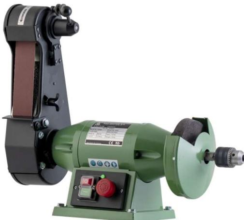
Specialschleifer zum schleifen von Schuheinlagen.
