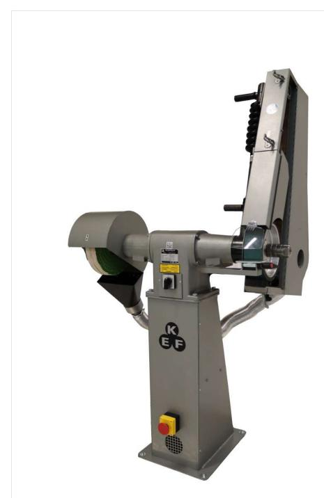
KEF POD 10 POLIERMASCHINE MIT ABSAUGUNG - für harte Arbeit geschaffen! Das Modell POD 10 von KEF ist mit ihrer soliden Konstruktion und dem kraftvollen Motor die ideale Poliermaschine für alle, die ein starkes Werkzeug für alle gängigen Einsatzbereiche brauchen und gleichzeitig Wert auf den hohen Arbeitsschutz legen, den die Poliermaschine dank minimalem mechanischen und elektrischen Staubniveau bietet. Die Spindelachsen sind mit staubdichten Kugellagern optimal gelagert. Die
