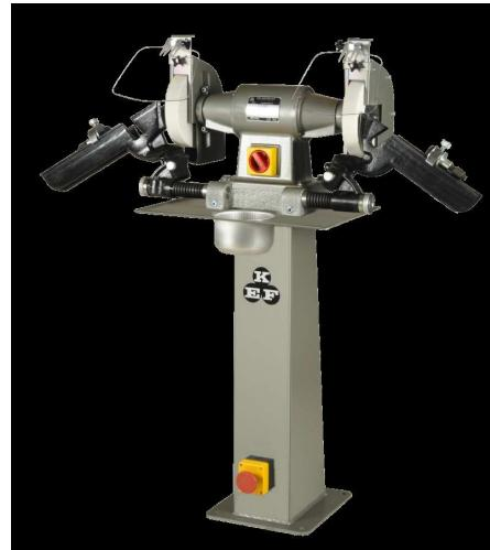
KEF PSD 5 mit Schleifen von Spiralbohrern KEF-Vorrichtungen sind für das Schleifen von Spiralbohrern mit einem Spitzenwinkel von 116-118 Grad und einem Hinterschliffwinkel von 6-8 Grad voreingestellt, d.h. die Bearbeitung von Stahl und Eisen. Außerdem ermöglicht der einfache Aufbau, dass eine große Auswahl verschiedener Bohrergrößen ohne kompliziertes Nachregulieren geschliffen werden kann. Deshalb wird auch ungeschultes Personal gute Schleifergebnisse erzielen.
