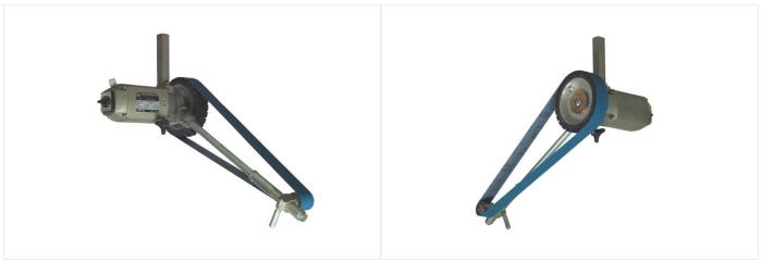
Rundschleifen an der Drehbank Die PSSE ist eine wertvolle Ergänzung des Maschinenparkes. Die Maschine ist für leichtes Schleifen und Polieren and einer Drehbank oder an einer anderene Maschine bestimmt. Die PSSE 3 ist eine kompakte Maschine mit einer sehr kräftigen Schleifscheibenwelle, die in drei grossen Kugellagern läuft. Die PSSE 3 hat einen starken, völlig geschlossenene drei-phasigen Motor und wird mit einem eingebauten Schalter und 5 Meter Kabel geliefert.
