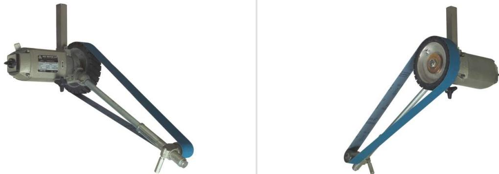
Rundschleifen an der Drehbank Die PSSE ist eine wertvolle Ergänzung des Maschinenparkes. Die Maschine ist für leichtes Schleifen und Polieren an einer Drehbank oder an einer anderen Maschine bestimmt. Die PSSE 3 ist eine kompakte Maschine mit einer sehr kräftigen Schleifscheibenwelle, die in drei grossen Kugellagern läuft. Die PSSE 3 hat einen starken, völlig geschlossenen drei-phasigen Motor und wird mit einem eingebauten Schalter und 5 Meter Kabel geliefert.
