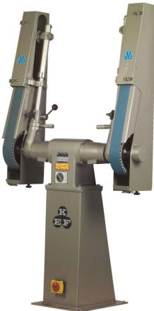
KEF professionelle kräftige Doppel Industriebandschleifer BO sich durch eine einfache zeichnen, aber starke stabile Konstruktion. Der große Abstand zwischen Schleifarmen macht diese Maschinen sehr geeignet für das Schleifen von gebogenen Einheiten. Die Maschinen sind mit ein und zwei Geschwindigkeiten erhaltbar und können mit einem Schleifband auf der einen Seite und Polierband auf der anderen Seite montiert werden. Ein niedriger Geräuschpegel, mechanisch, sowie elektrisch, sorgt dafür.
