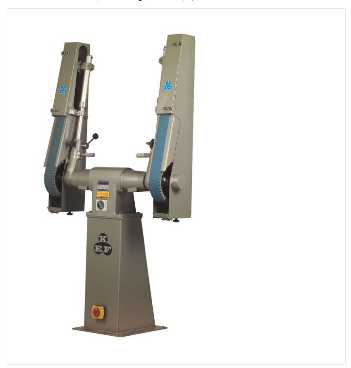
KEF professionelle kräftige Doppel Industriebbandschleifer BO sich durch eine einfache zeichnen, aber starke stabile Konstruktion. Der große Abstand zwischen Schleifarmen macht diese Maschinen sehr geeignet für das Schleifen von gebogenen Einheiten. Die Maschinen sind mit ein und zwei Geschwindigkeiten erhaltbar und können mit einem Schleifband auf der einen
