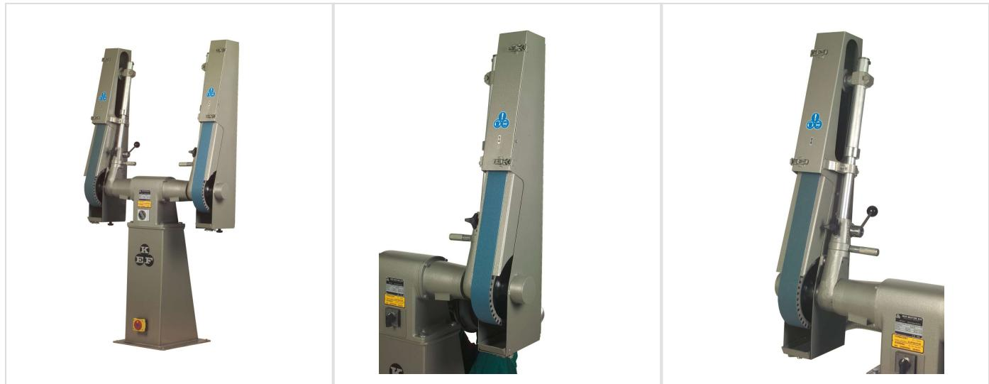
KEF professionelle kräftige Doppel Industriebandschleifer BO sich durch eine einfache zeichnen, aber starke stabile Konstruktion. Der große Abstand zwischen Schleifarmen macht diese Maschinen sehr geeignet für das Schleifen von gebogenen Einheiten. Die Maschinen sind mit ein und zwei Geschwindigkeiten erhaltbar und können mit einem Schleifband auf der einen Seite und Polierband auf der anderen Seite montiert werden. Ein niedriger Geräuschpegel, mechanisch, sowie elektrisch, sorgt dafür.
