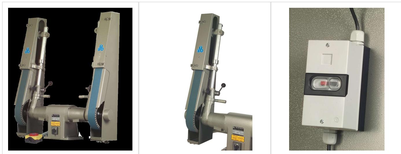
KEF professionelle kräftige Doppel Industribandschleifer BO sich durch eine einfache zeichnen, aber starke stabile Konstruktion. Der große Abstand zwischen Schleifarmen macht diese Maschinen sehr geeignet für das Schleifen von gebogenen Einheiten. Die Maschinen sind mit ein und zwei Geschwindigkeiten erhaltbar und können mit einem Schleifband auf der einen Seite und Polierband auf der anderen Seite montiert werden. Ein niedriger Geräuschpegel, mechanisch, sowie elektrisch, sorgt dafür.
