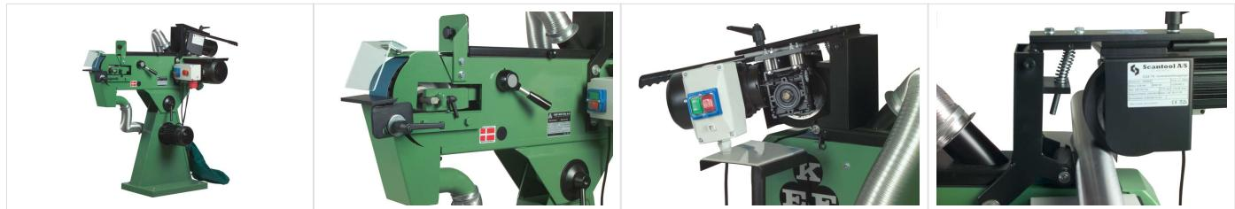
BHS 20-75 CG Centerless-Schleif- und Poliermaschinen zum Schleifen und Polieren von Rohroberflächen.
