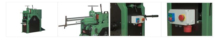
Rohrschleifer zum Schleifen aller Arten von Rohren und Profilen vor dem Schweißen.
