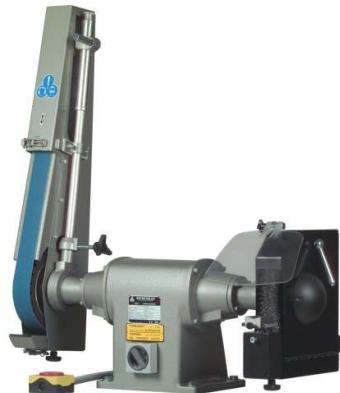
Les ébavureurs professionnels KEF sont construits sur les moteurs puissants et de qualité de KEF Motor. Toutes les machines sont proposées avec et sans extraction ou préparées pour un système d'extraction central existant. Peut être livré sur colonne.
