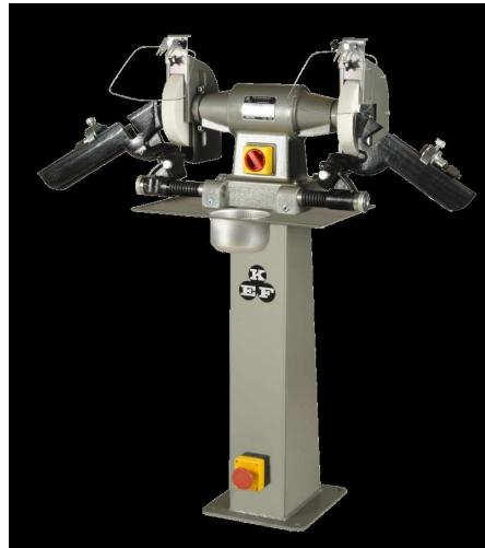
KEF PSD 5 avec affûteuse de forets L'équipement d'affûtage de forets KEF est prétréglé pour l'affûtage de forets hélicoïdaux pour l'acier et le fer avec un angle de pointe de 116-118 degrés et un angle de coupe de 6-8 degrés. La conception simple permet de rectifier un grand nombre de forets de tailles différentes sans réglages compliqués et chronophages. Les meilleurs résultats peuvent être obtenus par n'importe qui - instructions simples incluses.
