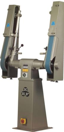
Les ponceuses à double bande industrielles professionnelles KEF BO se caractérisent par une construction simple mais solide et stable. La grande distance entre les bras de meulage rend ces machines particulièrement adaptées au meulage d'objets courbes. Les machines sont proposées avec une ou deux vitesses, et peuvent être équipées d'une bande abrasive d'un côté et d'une bande de polissage de l'autre. Faible niveau sonore, tant mécanique qu'électrique.
