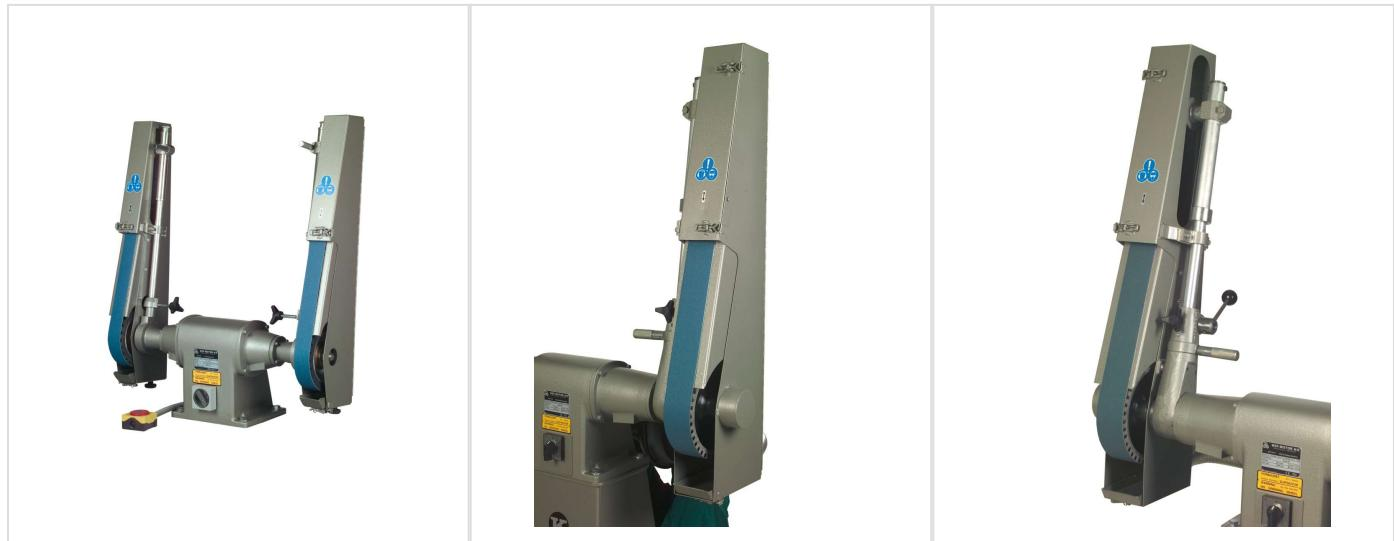
KEF professionnel puissant Doppel Industriebandschleifer BO sich durch eine einfache zeichnen, aber strong stable Construction. La grande distance entre les bras de meulage rend cette machine très appropriée pour le meulage des unités courbes. Les machines sont disponibles avec une ou deux vitesses et peuvent être montées avec une bande Schleifband d'un côté et une bande de polissage de l'autre côté. Un niveau de bruit inférieur, tant mécanique qu'électrique, garantit cela.
