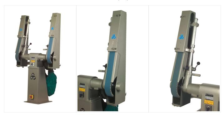
Les ponceuses à double bande industrielles professionnelles KEF BO se caractérisent par une construction simple mais solide et stable. La grande distance entre les bras de meulage rend ces machines particulièrement adaptées au meulage d'objets courbes. Les machines sont proposées avec une ou deux vitesses, et peuvent être équipées d'une bande abrasive d'un côté et d'une bande de polissage de l'autre. Faible niveau sonore, tant mécanique qu'électrique.
