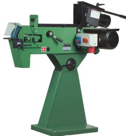
KEF BHS 20-75 CG Rectifieuse et polisseuse sans centre pour le ponçage et le polissage des surfaces de tuyaux.
