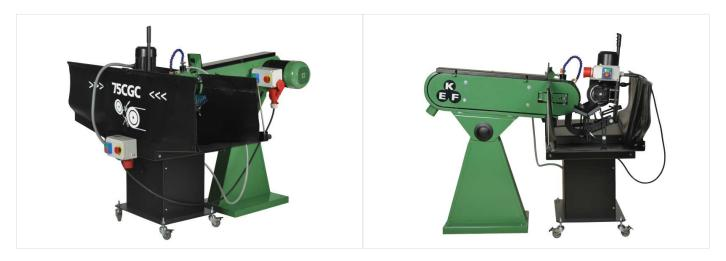
Rectifieuse et polisseuse centerless KEF CGC KEF CGC est équipée d'une pièce latérale qui peut être montée sur toutes les ponceuses à bande avec une bande de 75 x 2000 mm et une grande surface de meulage sur le dessus.
