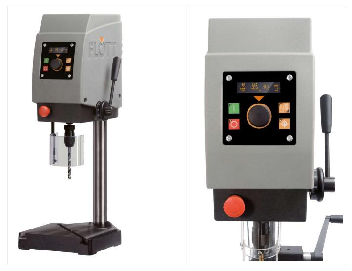
FONCTIONS DU MENU  $\cdot$  Menu de saisie clair et compréhensible  $\cdot$  Sélection du mode entre perçage et taraudage  $\cdot$  Deux valeurs d'écran précises pour la profondeur et la vitesse de perçage cible et réelle  $\cdot$  Fonction de comptage des couches de perçage/taraudage  $\cdot$  Fonction de mémoire intelligente des paramètres définis  $\cdot$  Alimentation automatique mode de sauvegarde.
